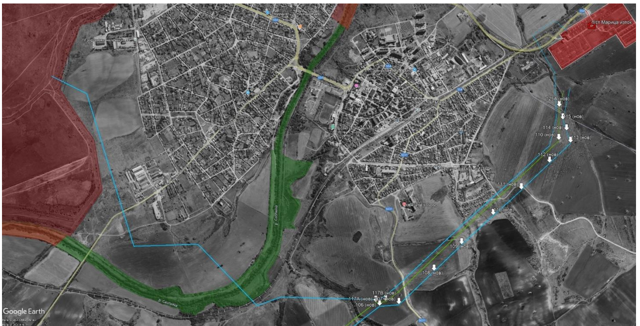
фигура 3 – трасе на нова ВЛ 110kV (с наложени зони Натура 2000, с номера стълбове)
