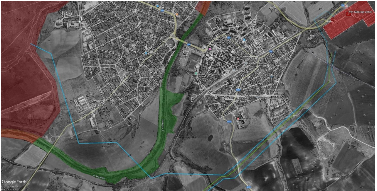
фигура 2 – трасе на нова ВЛ 110kV и изместени линии 220kV
